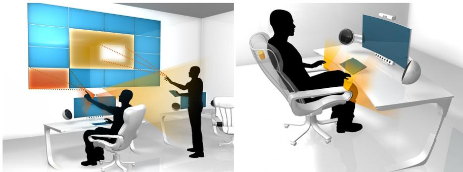
Abb. 2 Interaktion zwischen mehreren Benutzern/-innen mithilfe von Gestensteuerung (links); Operatorsessel mit Sensoren zur Gestenerkennung in der Armlehne und Vibrationselement in der Rückenlehne (rechts).
