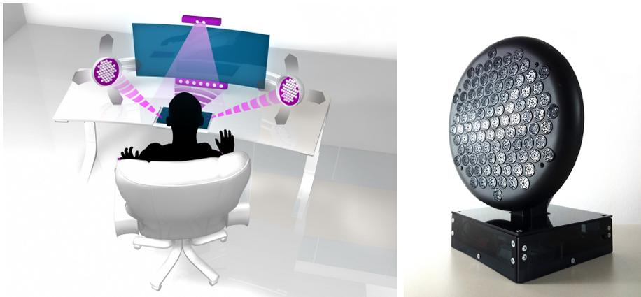
Abb. 7 Arbeitsplatz mit Tiefensensor und akustischem Interface (links); Lautsprecher mit Richtungssteuerung (rechts)
