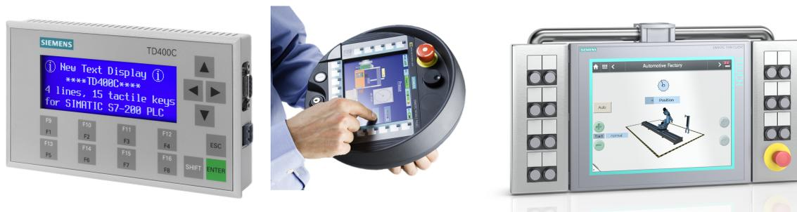
*Abbildung 1: Verschiedene Ausführungen von Bedienterminals (von links nach rechts): Textbasiert (Siemens AG 2009a: Text Display TD 400C), Mobil inkl. Touchscreen (Siemens AG 2009b: Mobile Panel 277F IWLAN) und Grafik inkl. Touchscreen (Siemens AG 2009c: THIN CLIENT PRO 15 Zoll mit Erweiterungseinheiten)*
