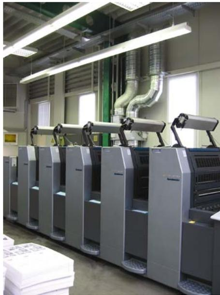
Abb. 16: Heidelberg Speedmaster SM 52 mit UV-Trockner
