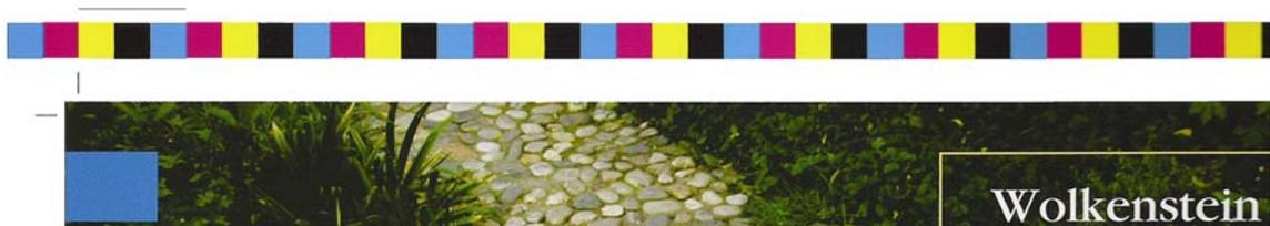
Abb. 9: Druckkontrollstreifen zur Messung der Farbschichtdicke mittels Densitometer
