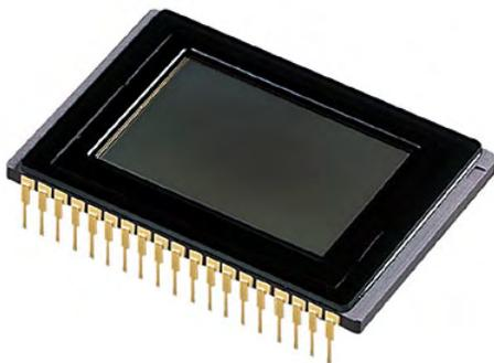
**Abbildung 2-8: Der JFET LBCAST-Sensor von Nikon<sup>30</sup>**
