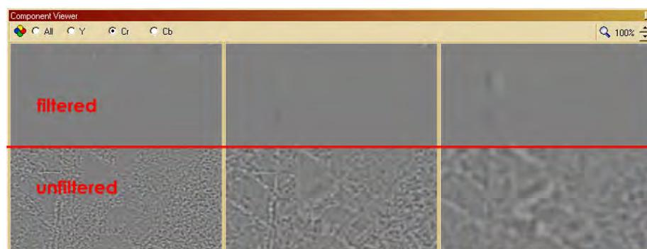
Abbildung 5-5: Cr-Komponentenansicht / hohe, mittlere und tiefe Frequenzen (von links)
