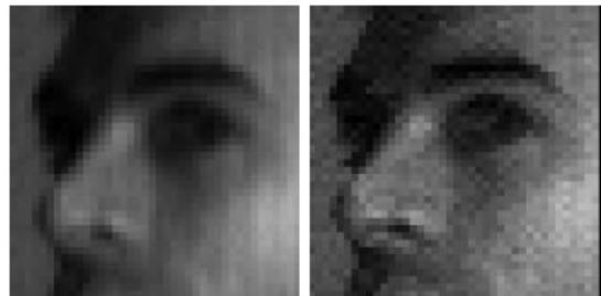
Abbildung 4-5: mit (links) und ohne CDS (rechts)<sup>69</sup>
