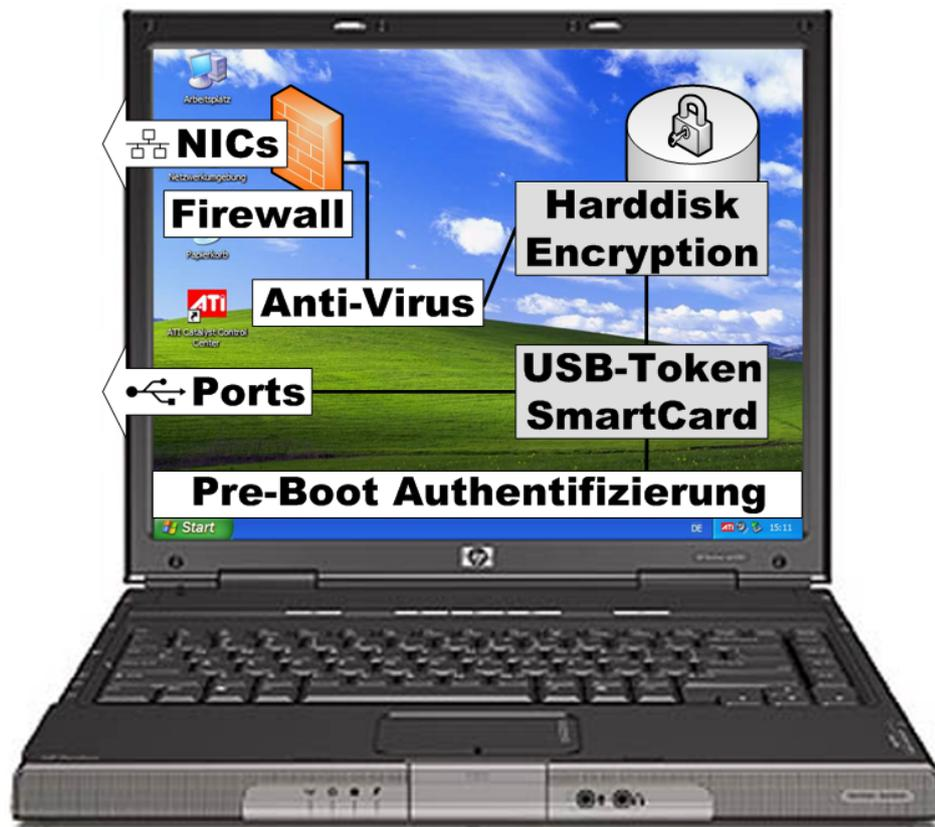
Abbildung 5.1: Teilkomponenten eines minimal abgesicherten mobilen IT-Clients
