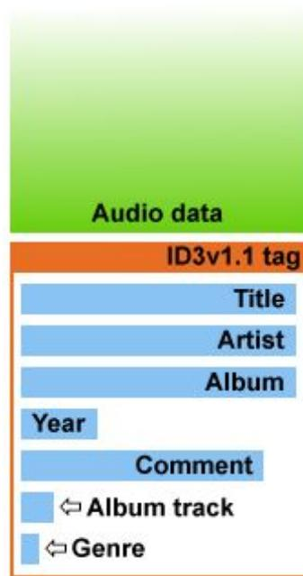
Abbildung 4.5: Blockdiagramm ID3-Tag Version 1
