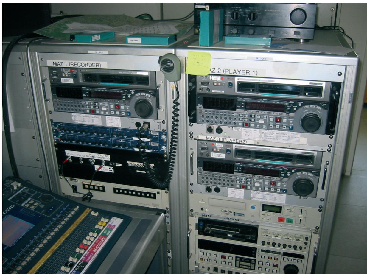
Abb. 46.1. Player und Recorder eines linearen Schnittsystems (Drilling ORF NÖ)
