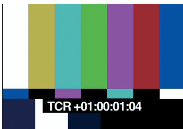
Abb. 49.1. Farbbalken mit Timecode (DV)
