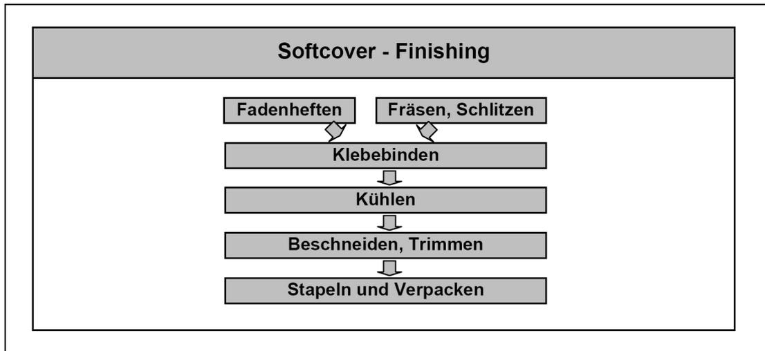
Abbildung 19: Prozessschritte bei der Softcover Fertigung
