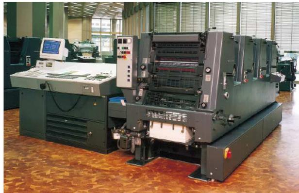
**Abb. 6:** GTO-DI/Sparc, Heidelberger Offsetdruckmaschine mit DI Technologie [8], S. 656
