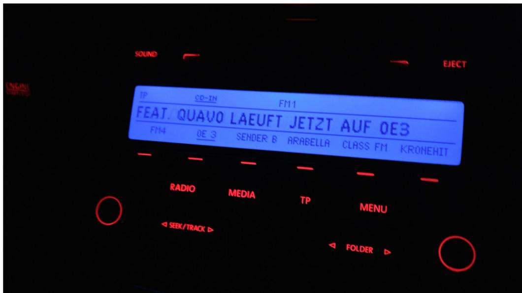
Abbildung 10: Beispiel für einen Radiotext via RDS
