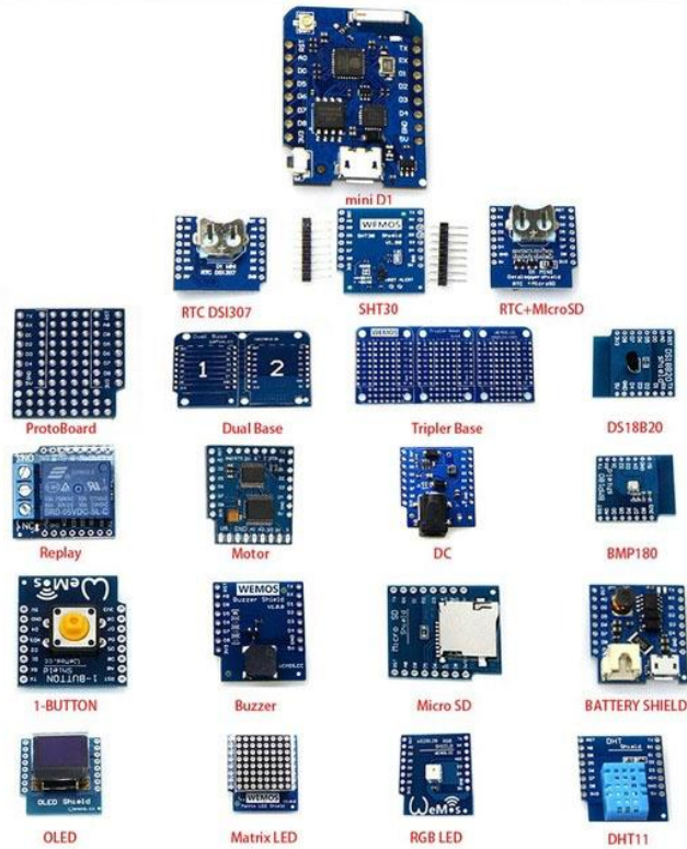
Figure 13: Wemos© D1 mini & available stackable shields [33]
