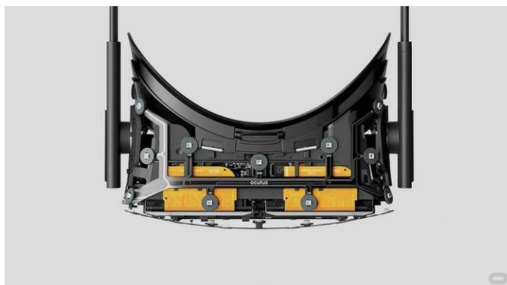
Abbildung 13: Innenleben der Oculus Rift mit Infrarot LEDs
