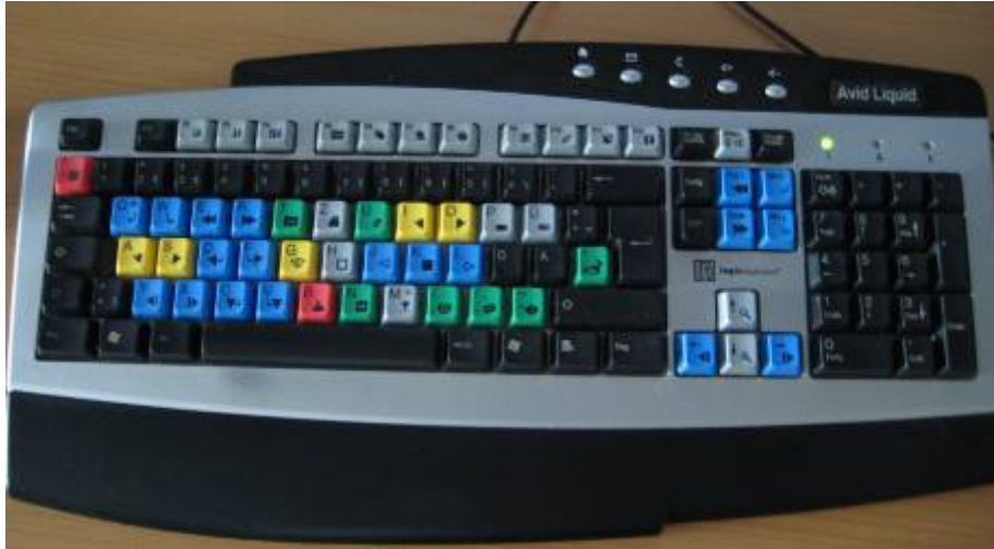
Abbildung 3.1: Avid-Tastatur; zum leichteren und schnelleren Schneiden sieht der Cutter Symbole der Shortcuts auf der Tastatur
