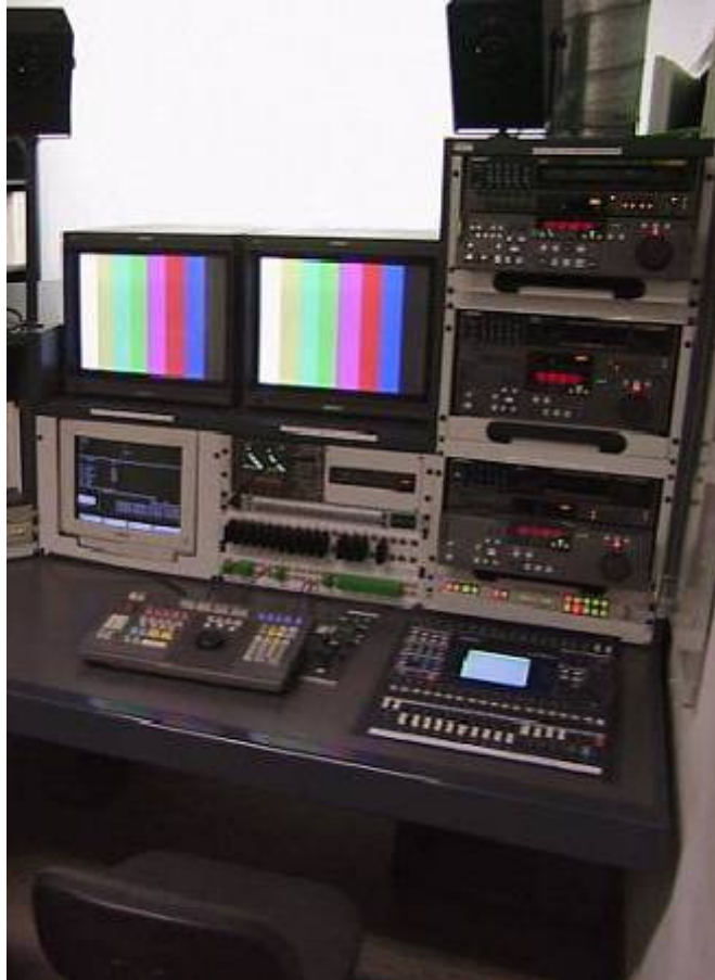
Abbildung 3.2.: linearer Drillingschnittplatz mit drei MAZen, davon zwei Player und ein Recorder, aus http://www.hff-muenchen.de/studium/2/6/videoschnitt/Videoschnittplatz.jpg , 19.12.2008
