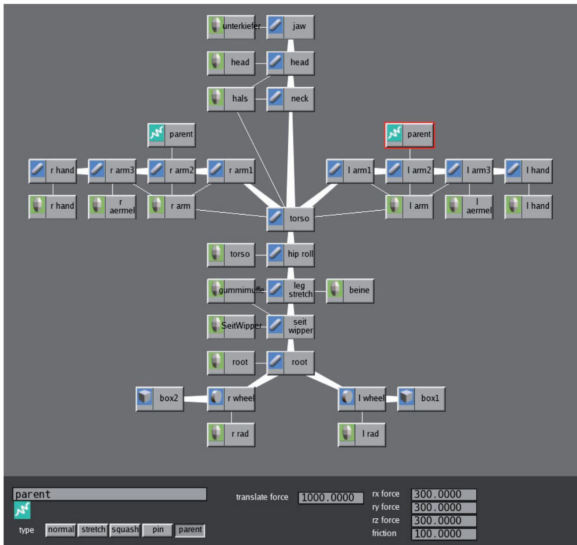
Abbildung 89: Spring Nodes am Rig des Banker Bot Agents
